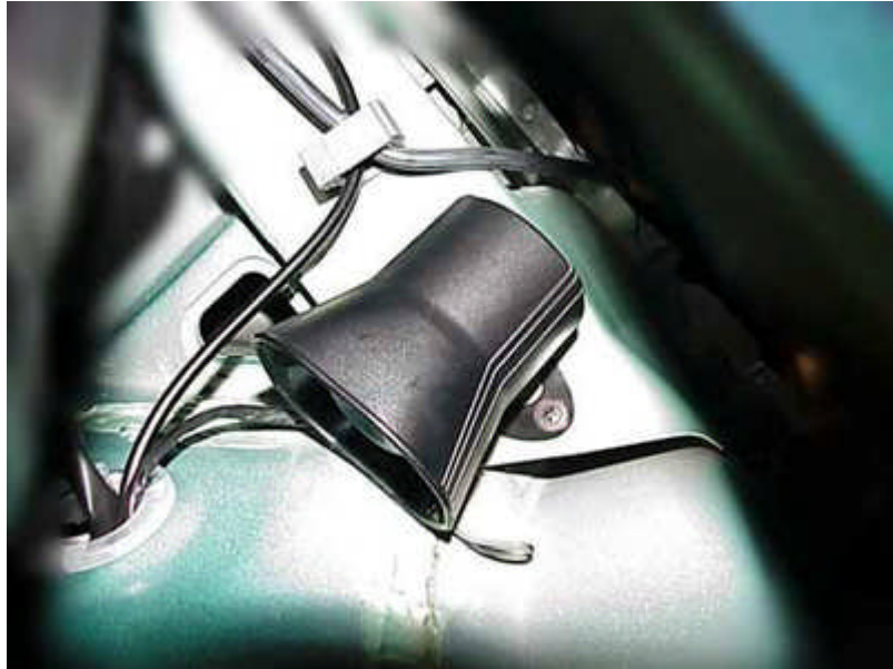
Una mini sirena, escondida dentro de la defensa de un vehículo.
